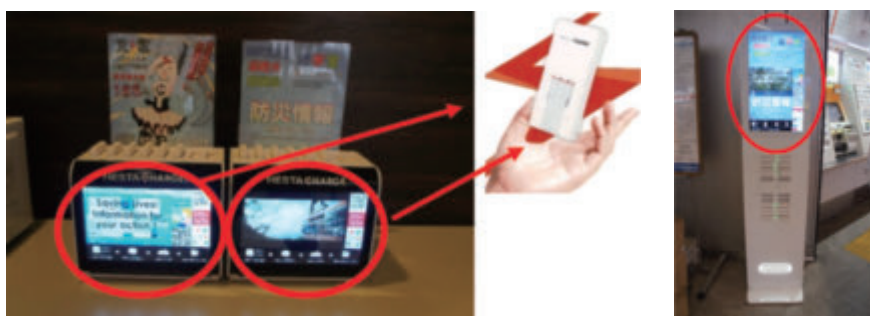
写真1(左) 実証実験で設置されているバッテリーチャージステーションスタンド(8口モデル, サイネージ10.1インチ)と搭載されているモバイルバッテリー本体
